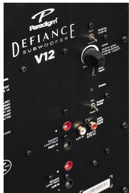
Wyposażenie, a nawet aranżacja panelu Defiance V12 jest nam już znana z subwoofera Martin Logan Dynamo 600X . Charakterystyczne jest tylko jedno pokrętko (poziome, pozostałe regulacje przeniesiono do aplikacji) i wejścia głośnikowe przyjmujące wtyki bananowe
