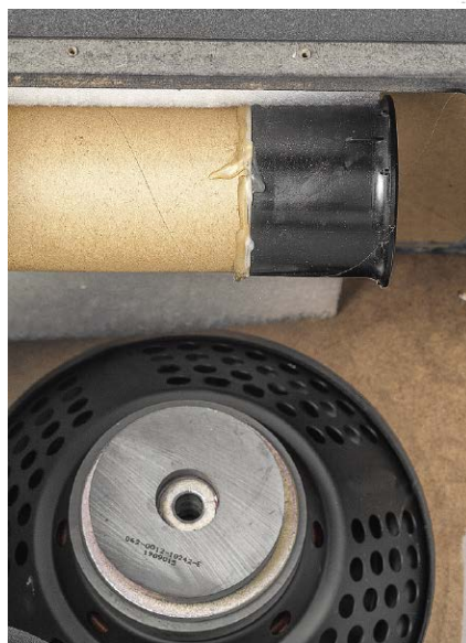
Tutaj tunel jest tak długi, jak na to pozwoliły wymiary obudowy; wewnętrzne zakończenie też jest wyprofilowane.
